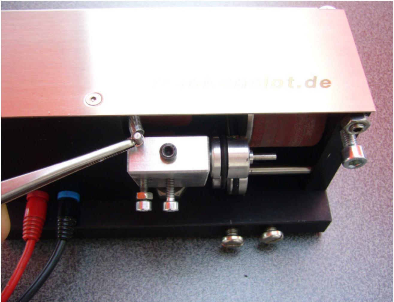
Abb. 1: Rückzugsfeder aushängen
