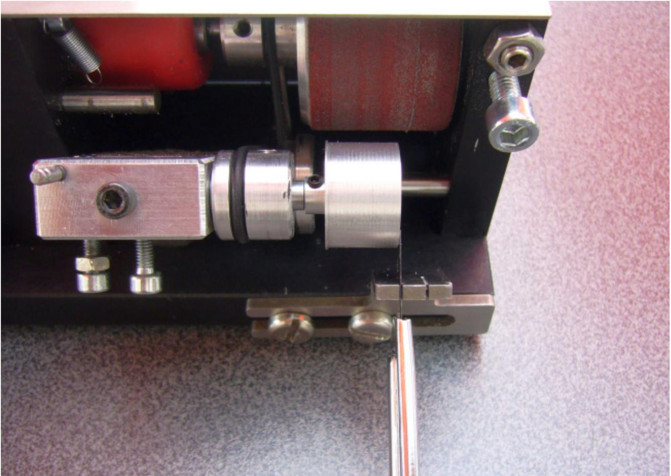
Abb. 3: Cutter in Führungsnut einlegen
