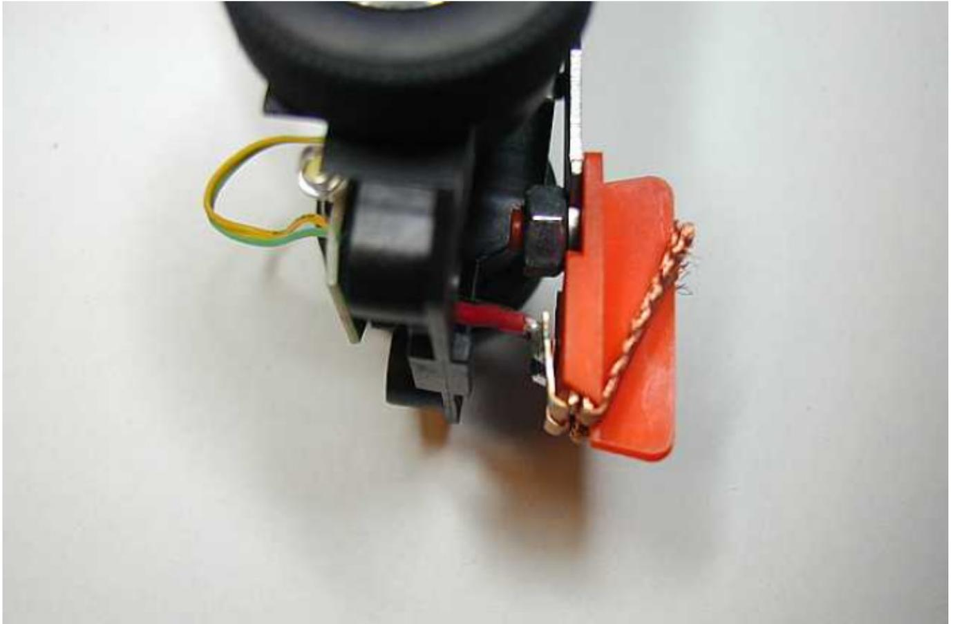
Lösen Sie die 4 Schrauben am Motorträger. Wir entnehmen den Motor/Hinterachsträger aus dem Chassis, entfernen nun die beiden Schrauben an der Hinterachshalterung und legen die alte Achse beiseite. Für den Flansch des Spurzahnrades muss der Ausschnitt mit einem Cutter vergrößert werden, wer will kann das auch ausfeilen.
